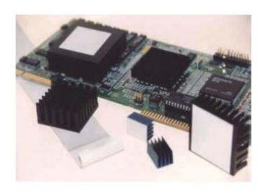
Sertek cuenta con varios materiales térmicamente conductores, con adhesivo en una cara, en las dos o sin adhesivo. Estos materiales son ampliamente utilizados para disipar el calor de chips electrónicos, baterías eléctricas, placas electrónicas...
